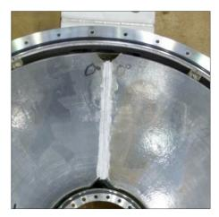
図 8: コアの間隔を FRP 板で調整した後に、RTV ゴ ムで切断面全体を覆い直接水に触れない様にした。
