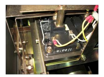
図 10: 損傷した IGBT。
