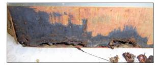
図 7: 空胴 6 号機加速ギャップ側コア端部。前回の 運転で損傷した端部のみが大きく損傷。
