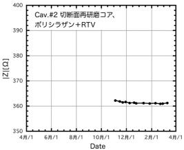
図 9: MR 空胴 2 号機インピーダンス変化。切断面再 研磨コア、切断面ポリシラザンコーティング後に RTV ゴムで切断面全体を覆ったコアを装填。
