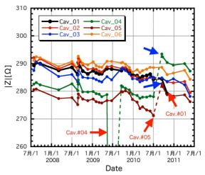
図 1: RF 空胴 1 から 6 号機までのインピーダンス測 定結果。縦軸は、共振点でのインピーダンスの絶対 値を示し、横軸は日時を示す。図中の赤矢印は座屈 によるインピーダンス低下を示す。破線はコア交換 を示し、青矢印は座屈対策(内部エポキシ樹脂含浸無 し)を施したコアとの交換を表す。
