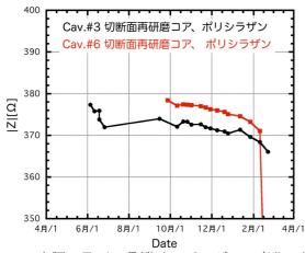
図 6: MR 空胴 3 及び 6 号機インピーダンス変化。切 断面再研磨コア、切断面ポリシラザンのコーティン グコアを装填。
