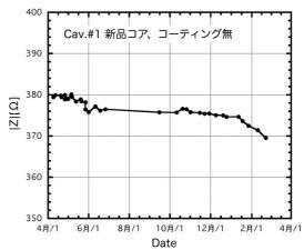
図 4: MR 空胴 1 号機インピーダンス変化。縦軸は、 共振点でのインピーダンスの絶対値を示し、横軸は
