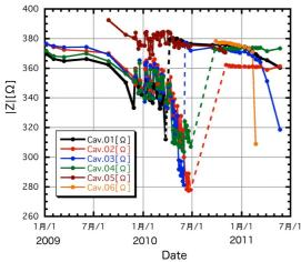
図 3: MR 空胴のインピーダンス測定結果。縦軸は、 共振点でのインピーダンスの絶対値を示し、横軸は 日時を示す。図中破線はコア交換を示す。
