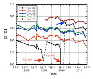
図 2: RF 空胴 7 から 11 号機までのインピーダンス測 定結果。縦軸、横軸及び図中の記号は図 1 と同様。
