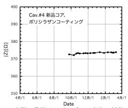
図 5: MR 空胴 4 号機インピーダンス変化。新品コア、 切断面ポリシラザンのコーティングコアを装填。
