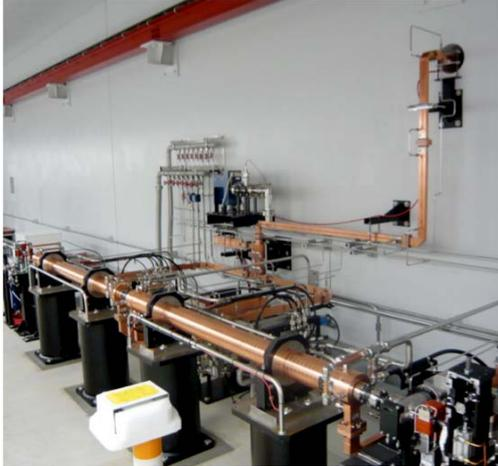
図 10 : 収納部での RF デフレクター空洞全体写真
