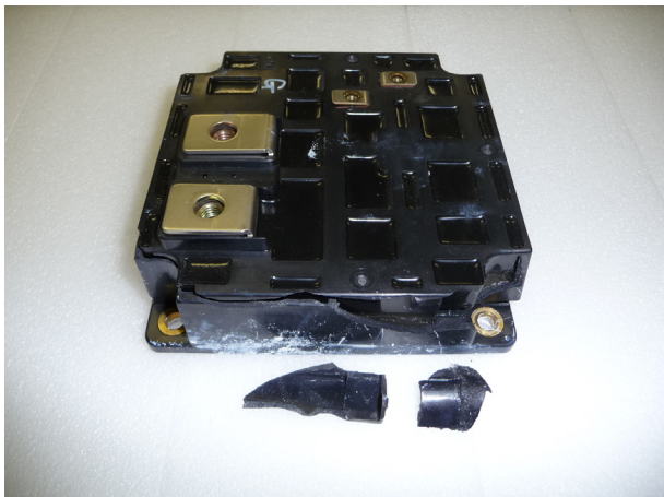
図 2 : 破損した自動電圧安定化装置の IGBT
