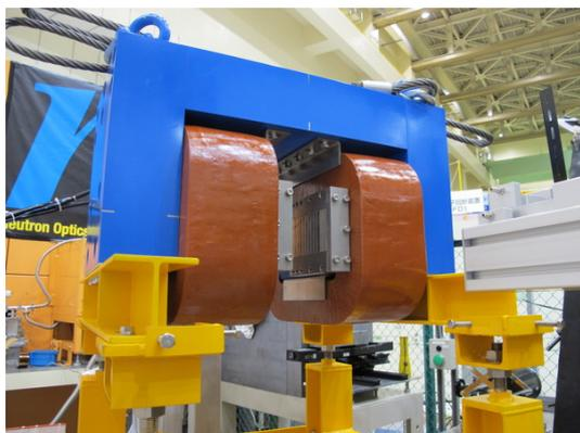
図 5: 製作された  $B_0$  電磁石
