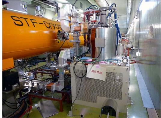
図 1 : DRFS 用クライストロンと超伝導空洞を収納したクライオモジュール
