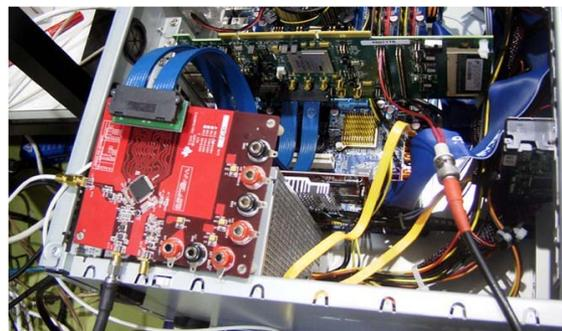
図 12 : 高速 ADC と FPGA 評価ボードによるダイレクトサンプリング試験
