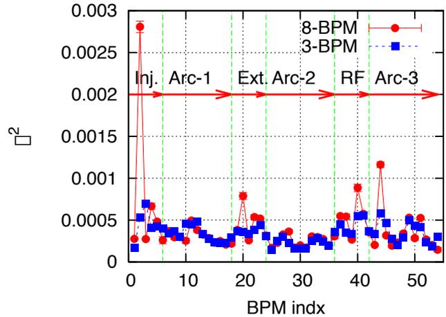
図 3: 連続する 3 つの BPM の垂直方向の分解能 ( $\sigma$ ) を同じと仮定した場合 (3-BPM )、とその仮定を置かない場合 (8-BPM )、の分解能を全周の BPM 54 台についてプロットした。RCS は、3 つの直線部、入射部 (Inj.)、出射部 (Ext.)、RF 部の 3 つの直線部とそれをつなぐ Arc 部からなり、その領域も図示した。
