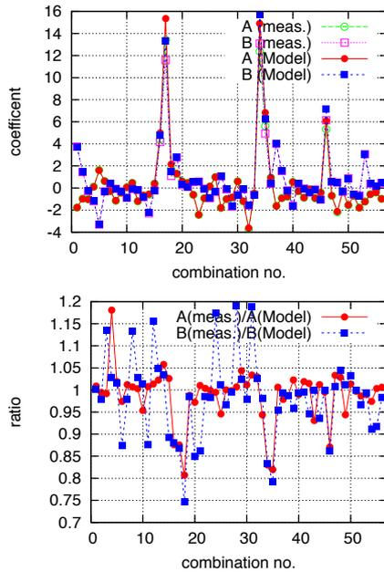
図 2: 測定及びモデルから得られる係数の比較。8 台の BPM サブグループからさらに 3 台を選ぶの組合せ毎に比較した。左が絶対値での比較、右は、モデルと測定の係数の比を示した。
