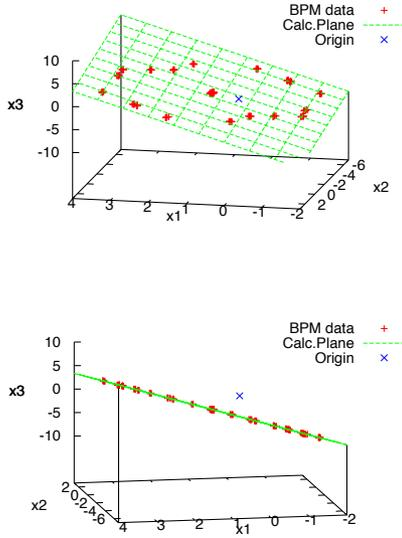
図 1: 3つのBPMの測定値。上下は測定点が同一平面上にあることが分かるよう参照角度を変更した。[3]
