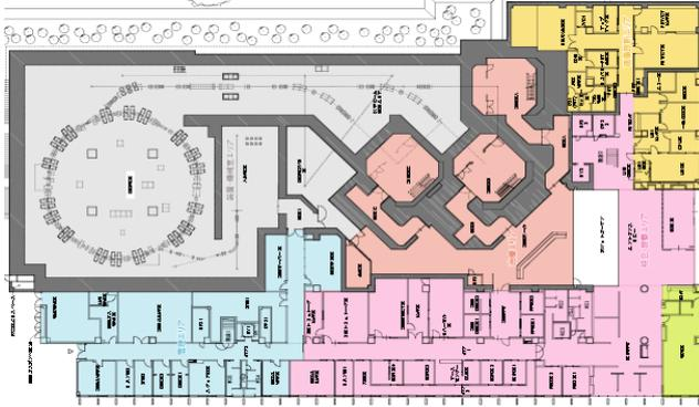
図4：施設全体の平面図、平面図はそのエリアの用途ごとに色分けして示している。加速器エリア（灰色）、照射室及び治療ホール（ライトサーモン）、画像診断エリア（オレンジ）、診察及び待合エリア（ライトピンク）、受付及び事務（黄緑）、治療具制作等（空色）。
