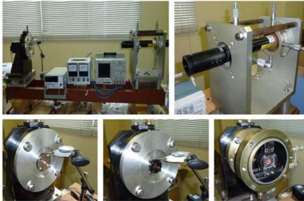
図3 PD校正システム(上左)と校正用レーザー(上右)とレーザー位置校正ジグ(下左)とPDのPDホルダー内位置調整(下中)と固定型PD(下右)
