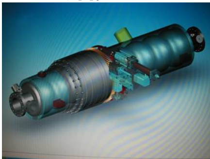
図1：開発中のLバンド高電界超伝導加速空洞 9連空洞で構成され、2 K温度下で加速周波数を1.3GHzに調整するためのSlow TunerとLorenz Force Detuningを調整するためのFast Tunerが取り付けられ
