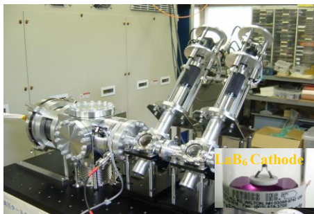
図2.低エミッタンスDC電子銃及びエミッタンスモニター、右下に1.75φのLaB6カソード。
