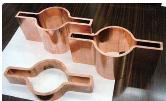
図3：冷間引き抜き法で形成されたダクトのカットモデル。
