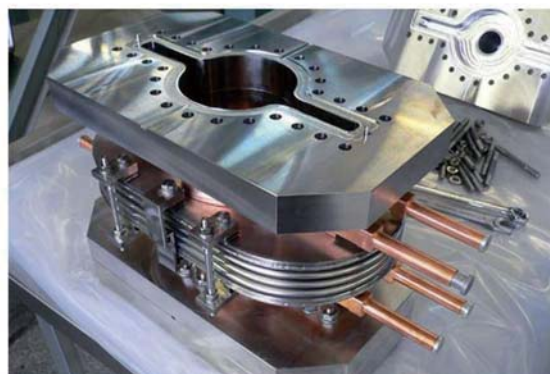
図5：アンテチェンバー付きビームダクト用のベローズチェンバー。フランジはMO型フランジである。
