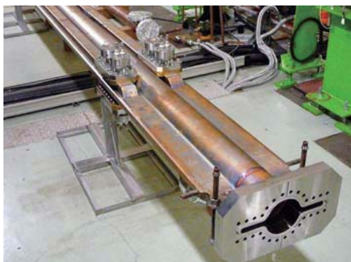
図1：試作したウィグラー部用アンテチェンバー付きビームダクト。
