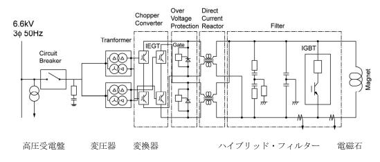
図1 新設の偏向電磁石電源の概念回路図
