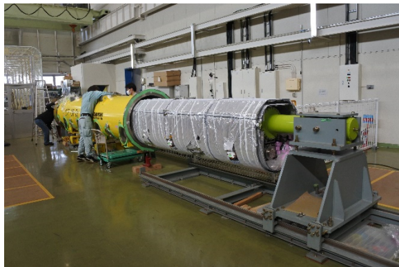
(e) Cold mass のクライオベッセルへのインストール
