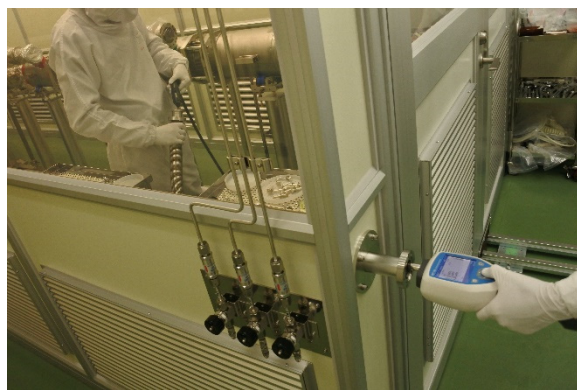
(c) リークチェック用配管のクリーニング
