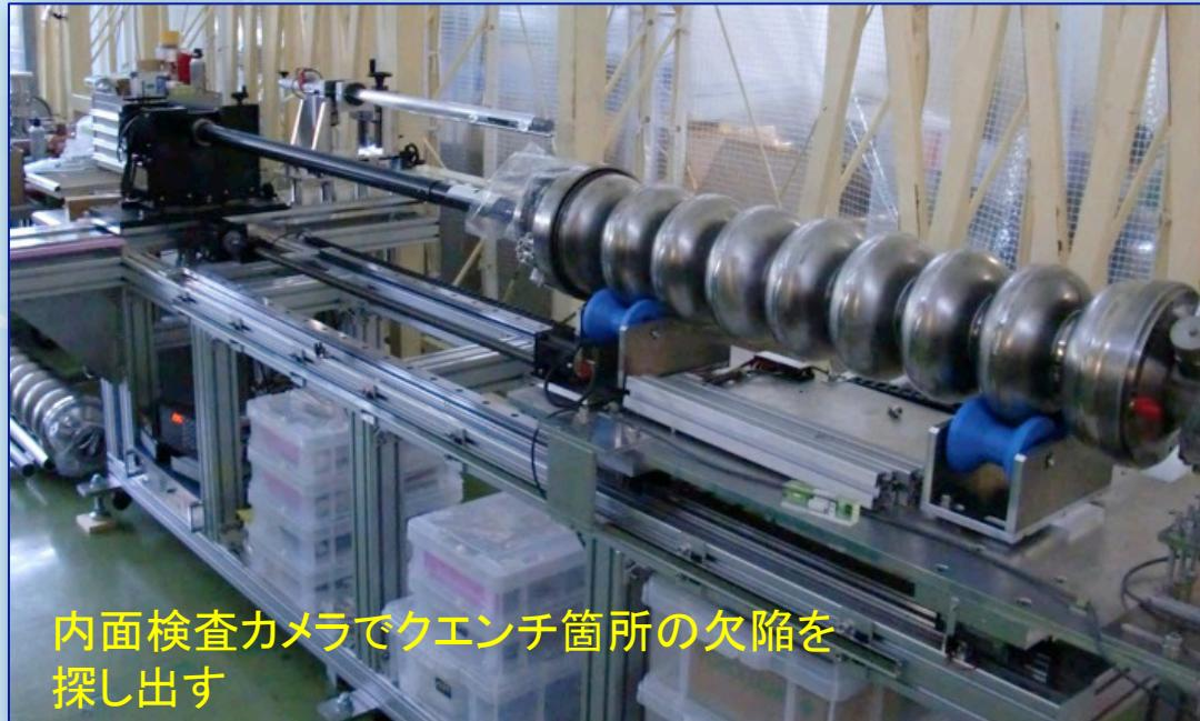
局所研磨機により、欠陥のある箇所のみ研磨し、欠陥を取り除く。
