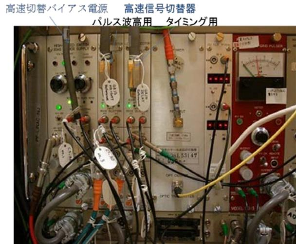
図8：高压ステーション内に組み込まれた電子銃ビーム高速切替システム
