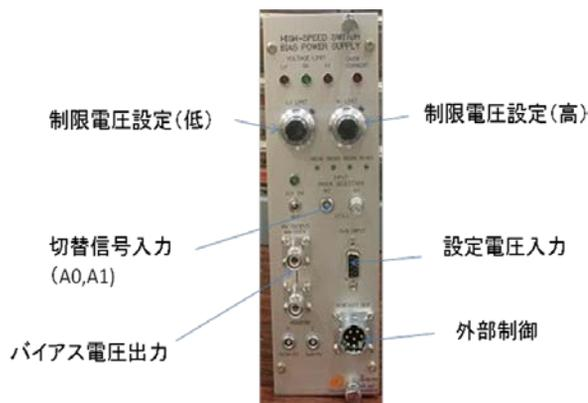
図3：高速切替バイアス電源のフロントパネル
