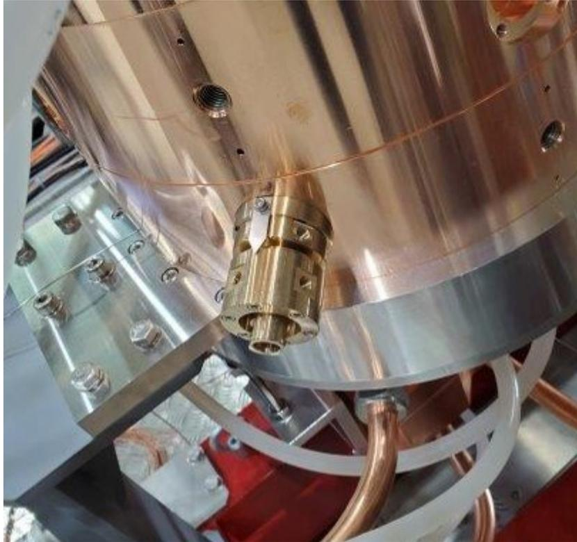
図 5.4. パルス圧縮器にチューナーを取り付けた図
