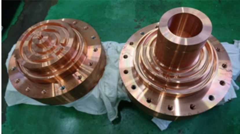
図 4.1. 中仕上げ加工までの部品写真
