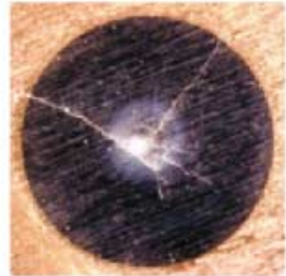
熱負荷等により損傷したSLCのW標的 (Snowmass2001)
