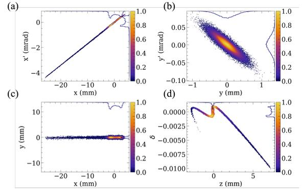
Figure 5: Particle distribution on the (a)  $x-x'$ , (b)  $y-y'$ , (c)  $x-y$ , and (d)  $z-\delta$  planes in Arc 1.
