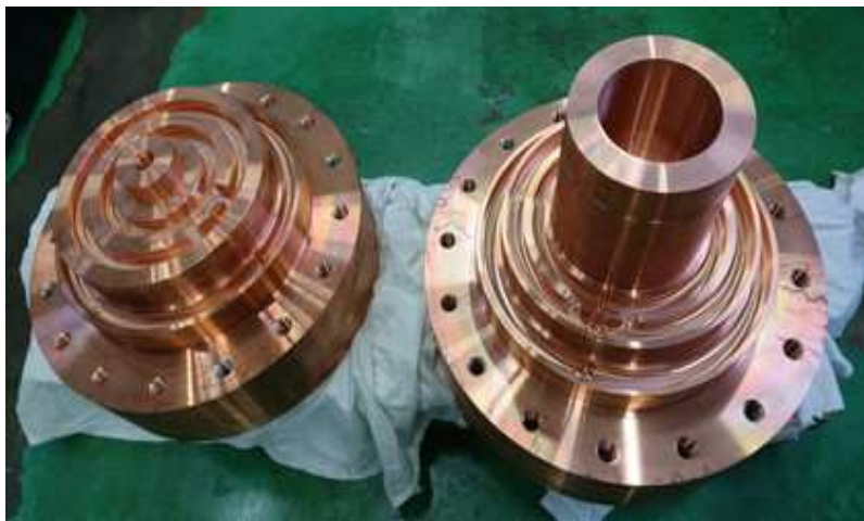
図4. 中仕上げ後の球形空洞半球： (左)ディチューナー側、(右)結合孔側
