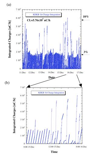
図3. (a) KEKB入射の1週間(12月11日から)と(b)1日(12月16日)の1時間積分電荷の時間推移。
