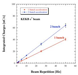
図1. ビーム繰返しに対する1秒積分電荷量の変化 (KEKB陽電子)。
