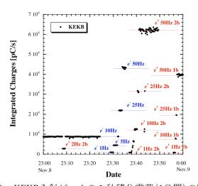
図 2. KEKB入射ビームの 1 秒積分電荷 (1日間) の時間推移。図中、1b(2b)は、1(2)バンチ入射であることを示す。
