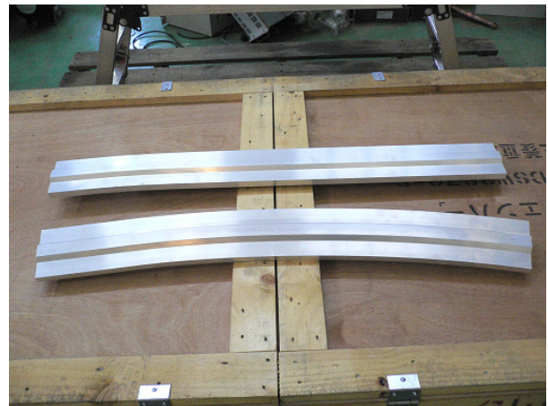
図8：曲げ加工されたビームダクト
