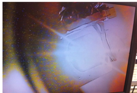
図 10: 124 Xe ビームにより光を放つ荷電変換膜 (46 価 → 52 価、炭素膜 22 mg/cm 2 )
