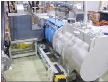
Fig. 10: 10MW Multi-Beam-Klystron.
