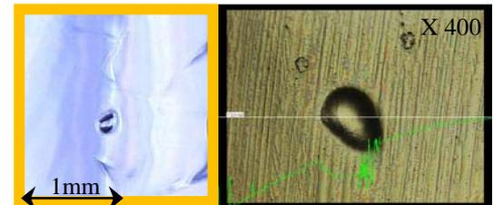
図9：2セル赤道部  $183^\circ$  に観察された凹状欠陥
