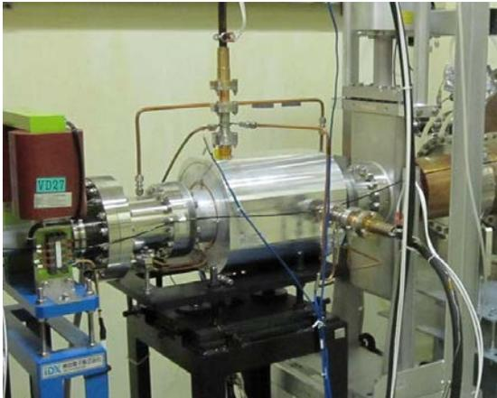
図 2：空洞型進行方向キッカー（DAFNE タイプ）
