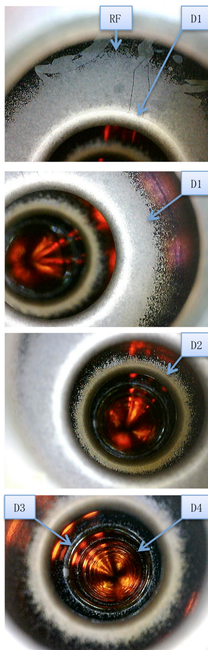
図 10 : 損傷の激しい加速管の写真
