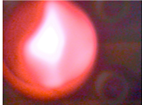
図 4 アルファ電磁石入射点でのビーム形状
