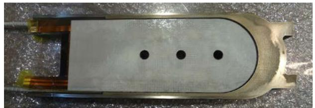
図5：完成した  $Nb_3Al$  コイル
