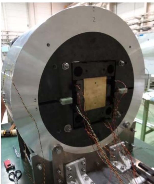
図 6：ダミーコイルを用いた磁石の仮組立
