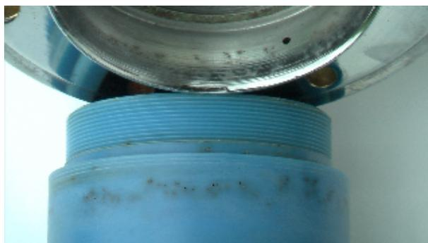
図5：アノード端子フランジ側の放電痕と孔
