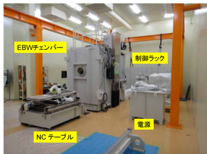
図 8 : パイロットプラントへの電子ビーム溶 接機の仮設置
