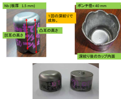
図 9 : HOM管の先進加工法
