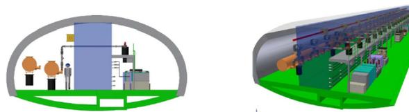
図4：NATM工法によるDRFS トンネル内レイアウト。左図はトンネル断面図。中央に放射線シールド壁(この場合は2.5m)、右図は俯瞰図。クライストロンは一樣に配置されている。機器は遮蔽壁を挟んで中央側に配置され、インストールなどの空間はトンネルの側面側に設けられている。
