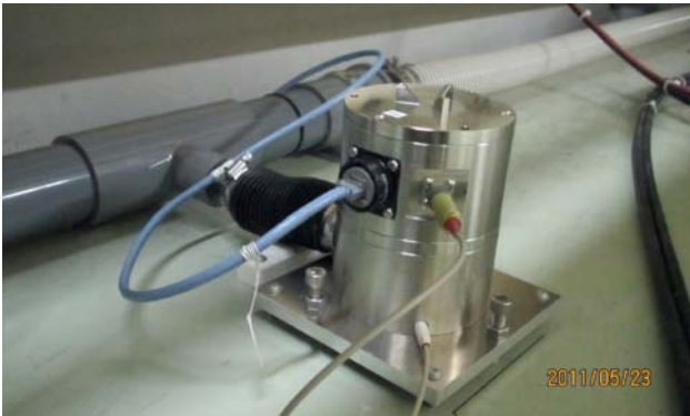
図3：HLS センサと配管
