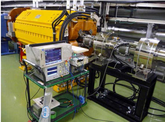
図 1: MR の 2 台の DCCT. 2mm<sup>3</sup> の鉄製の磁気シールドで覆われている。横は特性測定セット。
