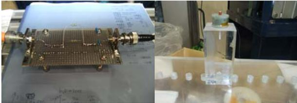
図 7：磁場確認回路の概略（上）および作成した磁場確認回路（積分回路：左、サーチコイル：右）
