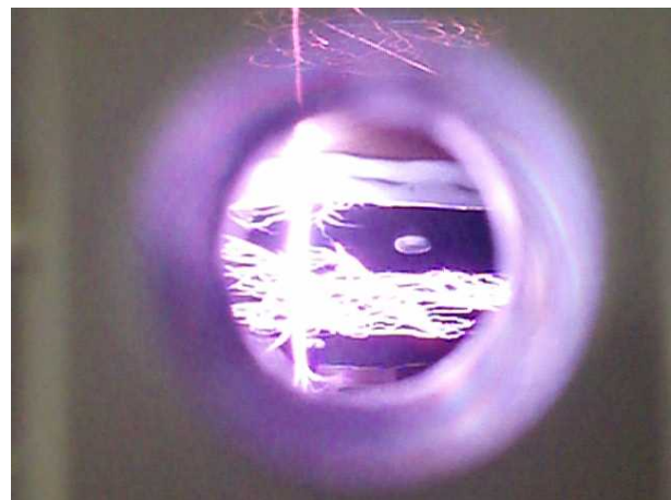
図7 全反射試験時でのサーキュレータ内部放電
