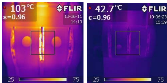
(a) 交換前 (b) 交換後 図6：ナイフスイッチ交換前と交換後の表面温度変化
