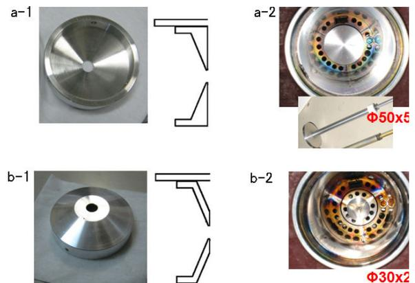
Fig. 2: プラズマ電極、及びバイアス・ディスクの形状: 図中のa-1とa-2、又はb-1とb-2の組み合わせで使用した。それぞれの場合をA), B)とする。
