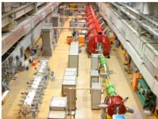
図6 . 既存の線型加速器（右）と 小型入射器（左）
