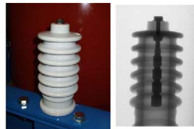
図 1 5 : 電極付き碍子(外径10cm) (左) とその X線透過像(右)
