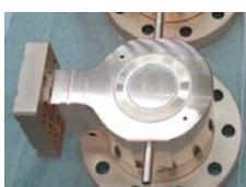
図4：モードコンバータろう付け品
