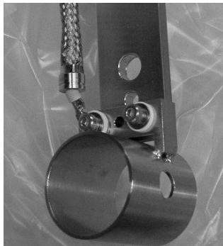
図 3: 運動量広がり測定用 Post Acceleration Tube の写真。側面の穴から見える蛍光を光電子増倍管で観測する。
