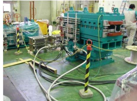
図12 通電試験中のバンブ電磁石
