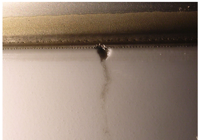
図3. 放電によるクライストロン電子銃碍子の欠損の様子。セラミックス表面に付いた筋状の汚れを拭き取ると、筋に沿って荒れた部分が露出した。
