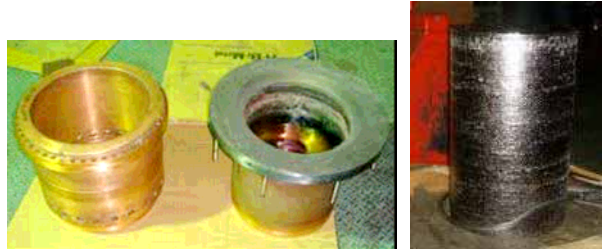
図2：東京電解(株)で製作された275 大口徑ニオブインゴット用ルツボ(左)と製作されたインゴット
