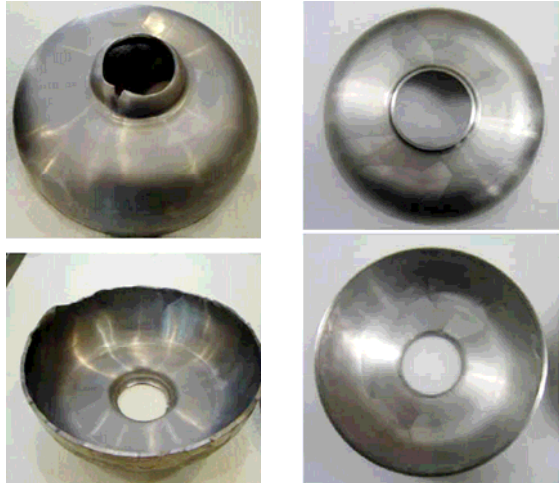
図5：スライス材からプレス成型したハーフカップ(左)とそのトリム加工後(右)
