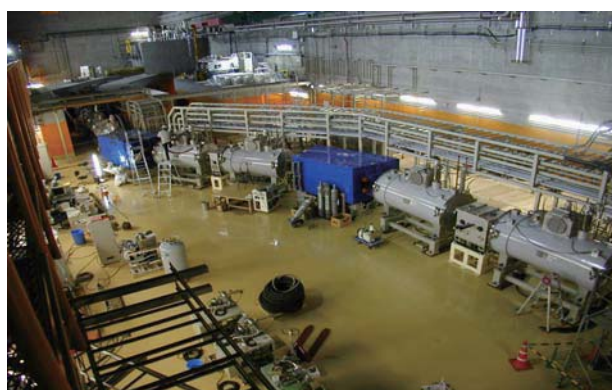
図5 超伝導RIビーム生成分離装置 (BigRIPS)
