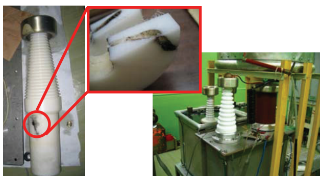
図7：（左）絶縁破壊をおこしたジュラコン碍子 （中央）損傷部の拡大 （右）再製作したテフロン碍子
