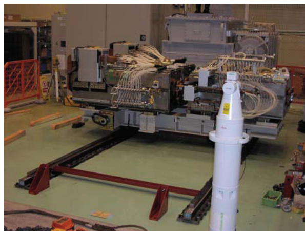
図5. セプタム電磁石を乗せ LMG を試験
