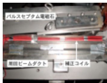
図6：補正コイルとパルスセパタム上流部の写真。
