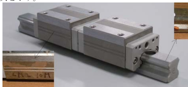
図1; 耐放射線性Linear Motionガイドと腐食部
