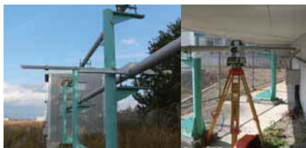
図5. トータルステーションを使用しての測定
